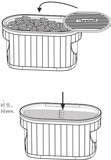
1. 拔下电源插头。拆下格栅。允许石蜡固化
